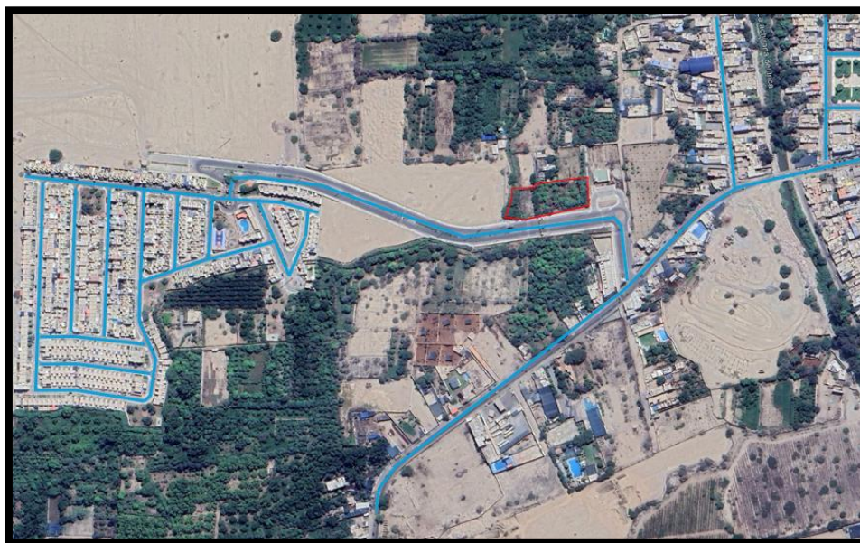
Imagen. - Red de Abastecimiento de agua potable en la zona.
