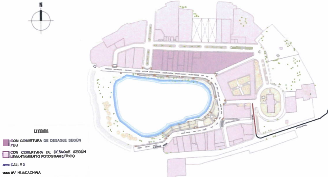
Imagen N°112: Abastecimiento de desagüe en el AUMH.
